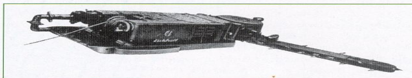
Obr. 311. Řetězový brázdící stroj Eickhoff s turbinovým motorem, kolem r. 1925. Reprofoto z knihy Kamenoubelné doly ostravsko-karvinského revíru
