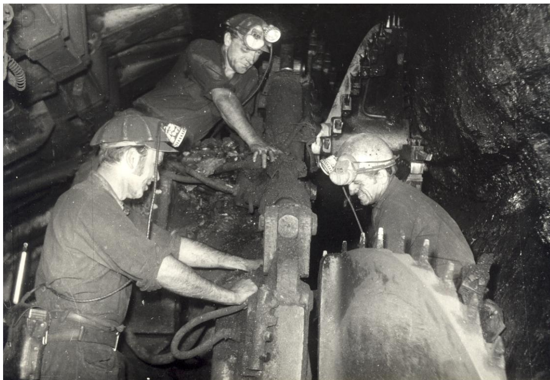
Rámová posuvná výztuž KM 87 s kombajnem 2K-52
