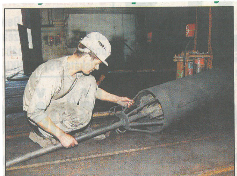
Do zasypávaných jam jsou každodenně spouštěny sondy „raketty“, které měří nejen hloubku, ale také složení vzduchu uvnitř jam.
