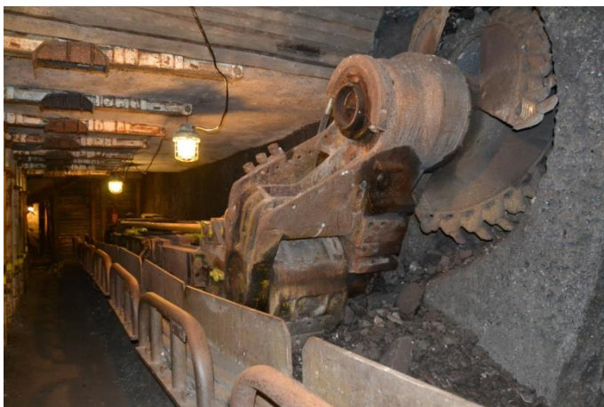
Moderní rozpojování uhelné sloje pomocí kombajnu.
